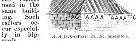
A, A, Jack-rafters ; B, C, hip-rafters .
